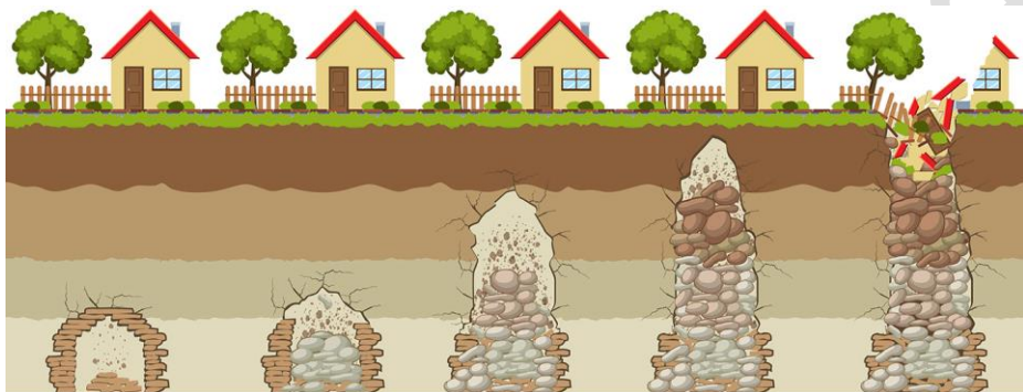
Effondrements localisés ou fontis - Géoderis
